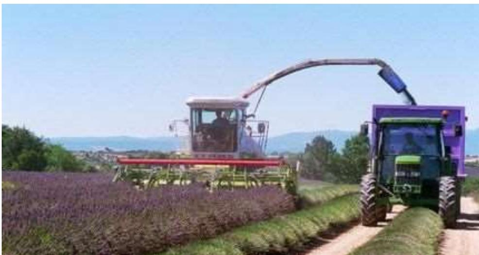
Lors de la récolte, les tiges ou les épis (procédé Espieur) sectionnés par l'organe de coupe de la récolteuse (1, 2, 3 rangs) sont happés par des rouleaux, hachés par des couteaux et projetés par une turbine dans une trémie portée à l'arrière du tracteur, ou dans un caisson de distillation (capacité de 14 à 26 m<sup>3</sup>) tracté à côté de la récolteuse.
